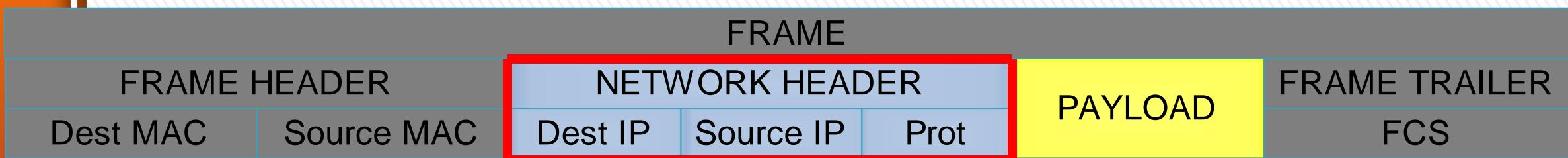
Opsi “use-ip-firewall” akan memaksa bridge untuk membongkar frame hingga level network
