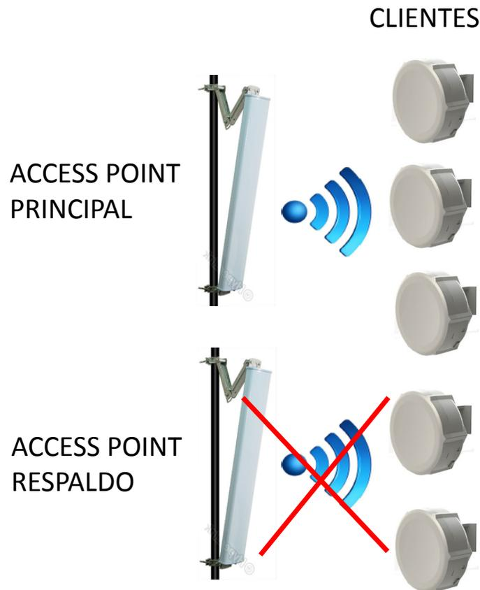
CON ESTE EJEMPLO DE APLICACIÓN NOSOTROS REALIZAMOS PROTECCION CONTRA FALLOS EN INTERFACES ETHERNET O DESCONEXION DE CABLES SIEMPRE Y CUANDO LOS ROUTERS CON SUS SISTEMAS OPERATIVOS SE MANTENGAN ACTIVOS
